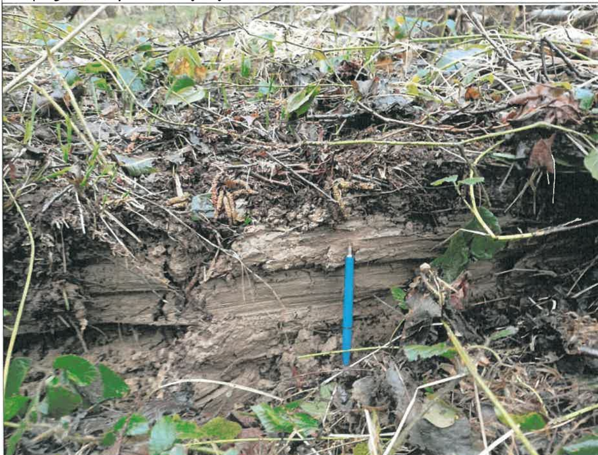
Powierzchnia poślizgu poniżej nasypu
